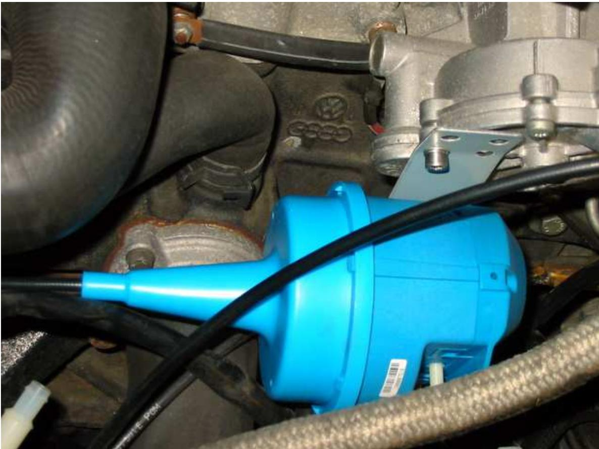
Den Servo habe ich jetzt wie Klaus (Danke !) an der Unterdruckpumpe festgemacht. Die Schraube habe ich durch eine Längere ausgetauscht und mit Sprengring und Unterlegscheibe gesichert.
