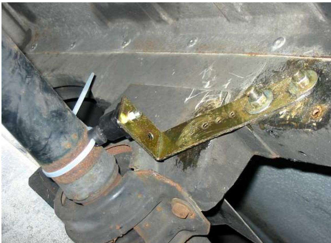
Da mein LT den langen Radstand hat, habe ich den Geschwindigkeitsgeber an das waagrecht verlaufende Stück der Kardanwelle angebracht. Entgegen diesem Bild habe ich nach der Testfahrt 2 Magnete angebracht, da die Kardanwelle eine eindeutige Unwucht hatte (Hätt ich nie erwartet, daß dieser kleine Magnet soviel ausmacht. Hat bei ca. 80 km/h gebrummt wie ein alter Trafo 2. Magnet dran, Brummen weg !)
