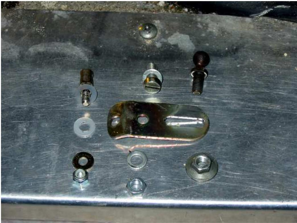
Hier die Anlenkung für den Gaszug, umgearbeitet aus dem beiliegenden Lochblechstreifen.
