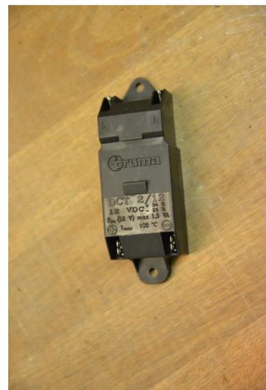
Die Kabel am **Zündautomaten** sind nur gesteckt. Fehlerbild bei defekter Zündung: Heizung springt kalt aber in heißem Zustand nicht an. Das Tackern des Hochspannungsfunkens ist nicht zu hören. Man hört dann am Kamin nur ein ‚Rauschen‘ ( Korona-Entladung?), da der Zündautomat nicht genug Hochspannung aufbaut (Austausch ca. 110€).
