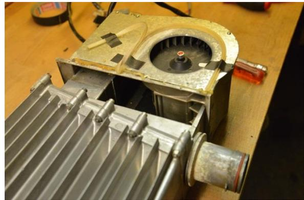
Ansicht auf Gasrohr und Düse (50 mb), großes Lüfterrad, darunter das schmale Lüfterrad für die Verbrennungsluft (nicht sichtbar).
