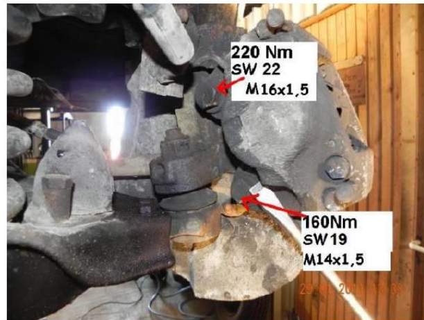
Anzugsdrehmomente Bremssattel
