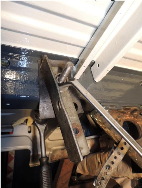
Das Lager kann nun mühelos von der Einziehilfe in den Rahmen eingezogen werden, da es auf den richtigen Durchmesser „komprimiert“ ist.
