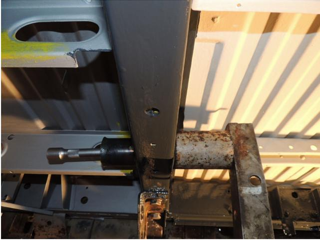
Die andere Seite sieht nach abgenommener Hülse (das Lager wurde ganz durchgeschoben) dann so aus. Zu sehen die Unterlegscheibe, welche das Gummi drückt. Diese darf nicht zu groß gewählt werden, da Sie samt nach hinten gebogenem äußeren Gummirand des Lagers durch die Einziehilfe passen muss
