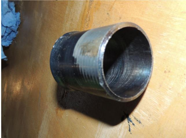
Die Seite mit den 50mm Innendurchmesser wurde zusätzlich mit der Flamme erhitzt und so aufgebördelt, dass das der größte Durchmesser des Gummilagers beim Beginn des Pressvorgangs dort nicht verkanten kann.
