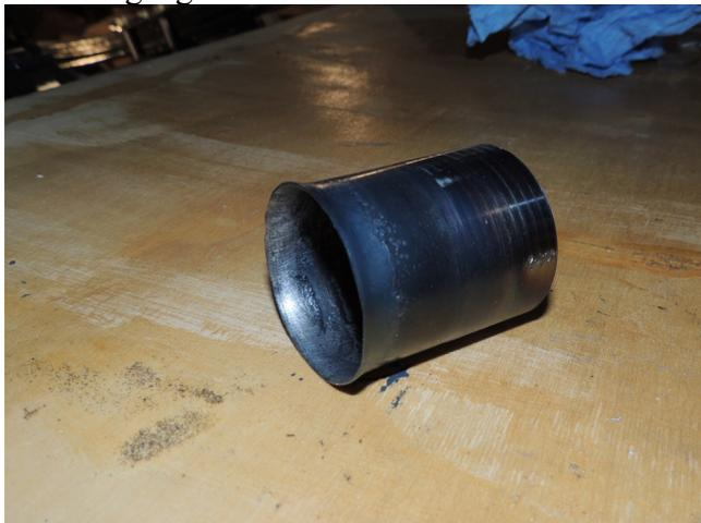
Das Lager wird mit nun einem großen Schraubstock zunächst in die Einziehhilfe gepresst.
