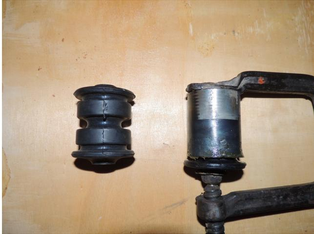
Die Einziehhilfe wird aus einem Stück Rohr gefertigt, etwas kürzer als das Lager. Innendurchmesser 45mm, Wandung 5mm oder mehr. Das Rohr habe ich innen konisch ausgedreht, sodass der Innendurchmesser auf einer Seite auf ca. 50mm vergrößert wurde. Auf der Seite mit den 45mm wurde ein kleiner „Grat“ gedreht (siehe nächstes Bild). Dadurch zentriert sich später die Einziehhilfe auf der Hülse am Rahmen.
