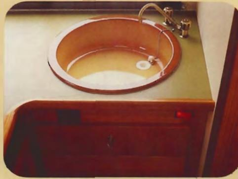
Die Heißwasserversorgung für Küche und Waschraum erfolgt über das Gassystem und ist elektronisch gesteuert. Je ein Tank für 70 l Frisch- und 50 l Abwasser sind serienmäßig. Ein 60-l-Zusatztank für Frischwasser ist Sonderausrüstung.
