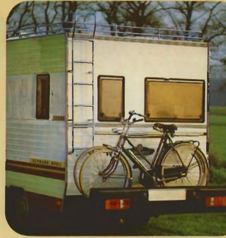
Die hintere Stoßstange ist mit dem herausziehbar Heckträger kombiniert. Damit läßt sich so allerhand zusätzlich transportieren! Wenn er nicht gebraucht wird, verschwindet er unsichtbar unter dem Fahrzeug ... und macht einer Anhängerkupplung Platz (beides ist als Sonderausrüstung lieferbar).
