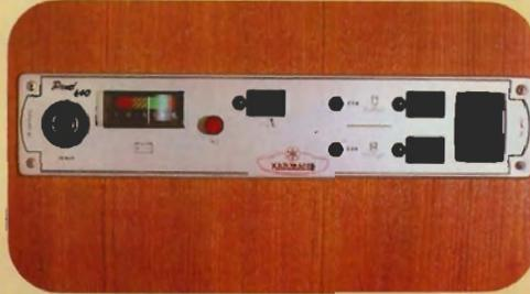
Elektronische Kontrollüberwachung und Sichtkonsole für Batterie, Frischwasser und Abwasser. Zweitbatterie mit Trennrelais und Ladeautomatik.
