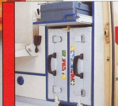
Zwei Arztkoffer sind handlich direkt neben der Seitentür untergebracht, wodurch auch von außen ein schneller Zugriff möglich ist. Darüber steht eine
