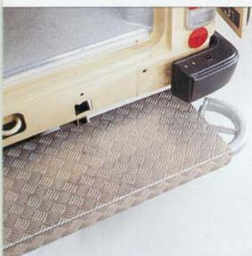
Der Heckauftritt, nach DIN 75080 aus feuerverzinktem Stahlblech, ist selbstverständlich rutschfest und bietet durch die eingekürzten Stoßstangenecken einen besonders breiten und sicheren Auftritt . Befestigt ist dieser durch Federstahlelemente, wodurch ein Ramm- und Auffahrtsschutz gegeben ist ■
