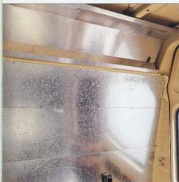
Die Beplankung aus stabilem, feuerverzinktem Stahlblech hinter den Verkleidungen läßt es zu, daß an jeder beliebigen Stelle medizinisch technische Geräte angebracht werden können ■
