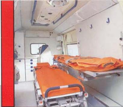
Die zweite Tragenlagerung ist als steckbares Haltesystem ausgeführt. Danach kann die Trage nach DIN 13024 schnell und sicher an der Seitenwand angebracht werden. Bei
