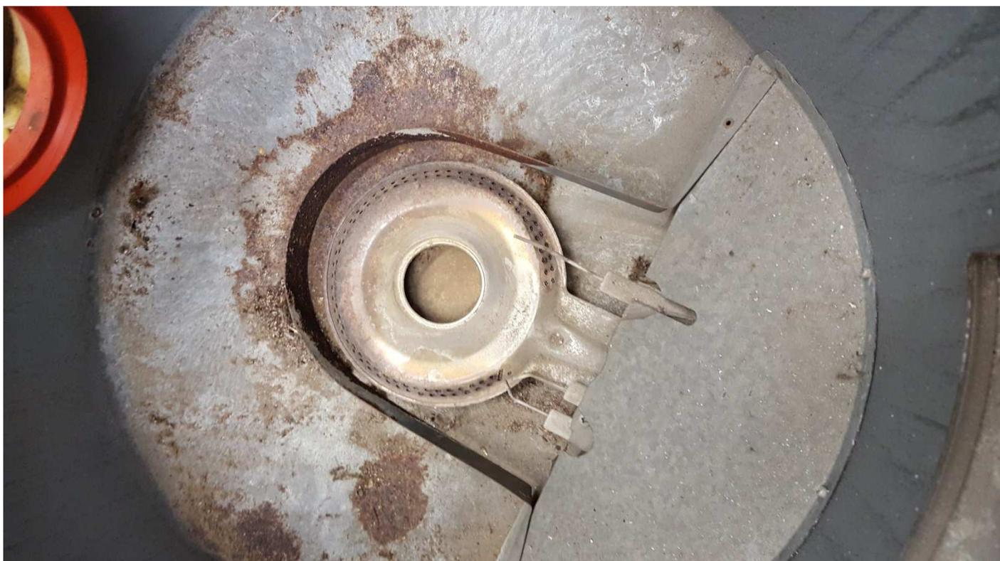
Der Boden innen ist ein bißchen rostig und schmutzig, teils auch durch Insektenreste, aber der Brenner sieht dafür daß er 26 Jahre nahe an der Witterung war noch gut aus. Ich reinige die Zündkerzenkontakte und den Flammwächter vorsichtig mit Stahlwolle. Der Brenner wird so lange abgedeckt.
