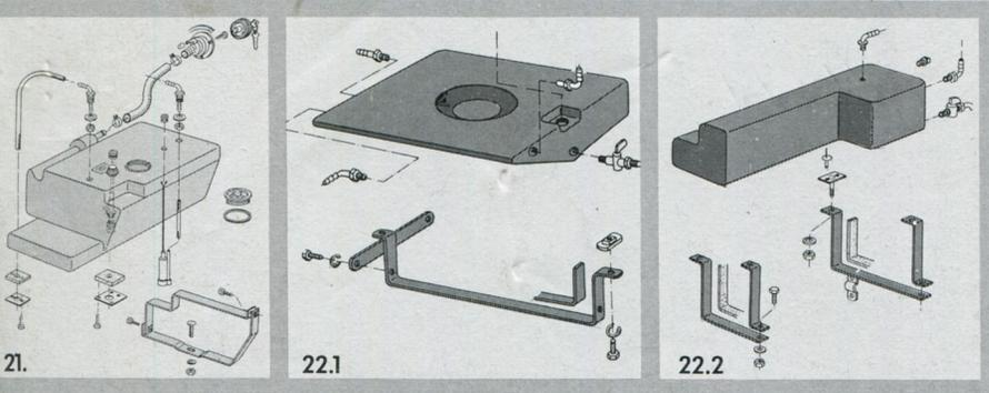
**21. Frischwassertank** speziell geformt für die hintere Westfalia-Variositzbank, Inhalt ca. 70 l, einbaufertig mit Befestigungselementen, Außenfüllstutzen abschließbar. Überlauf, Reinigungsöffnung und Bodenablauf.
