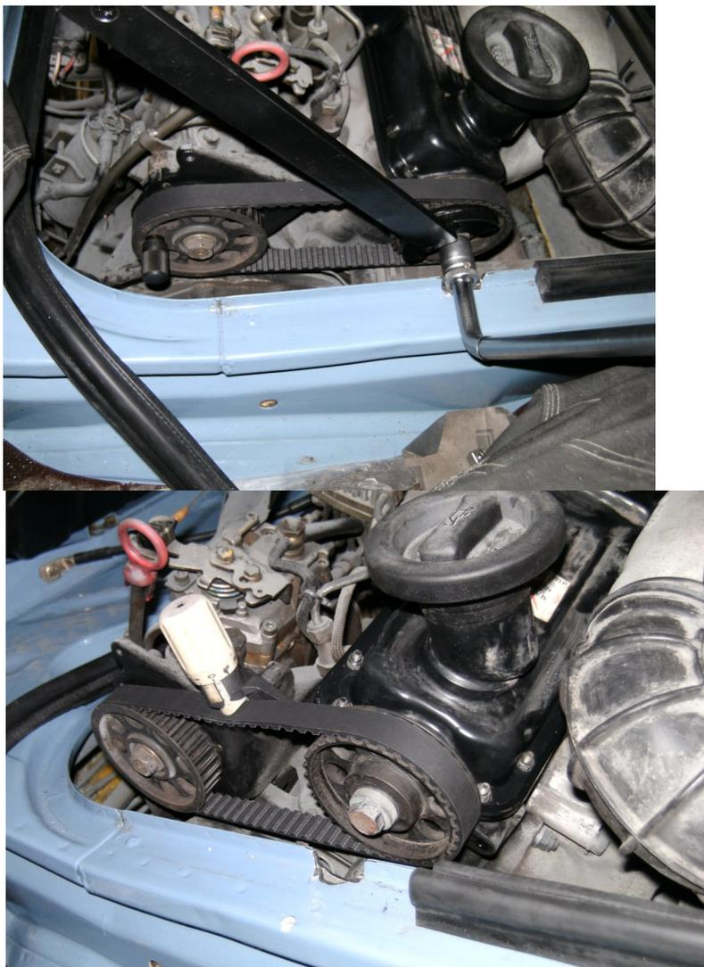
Die Riemenspannung kann hier durch verschieben der ESP Konsole und Stütze verändert werden.
