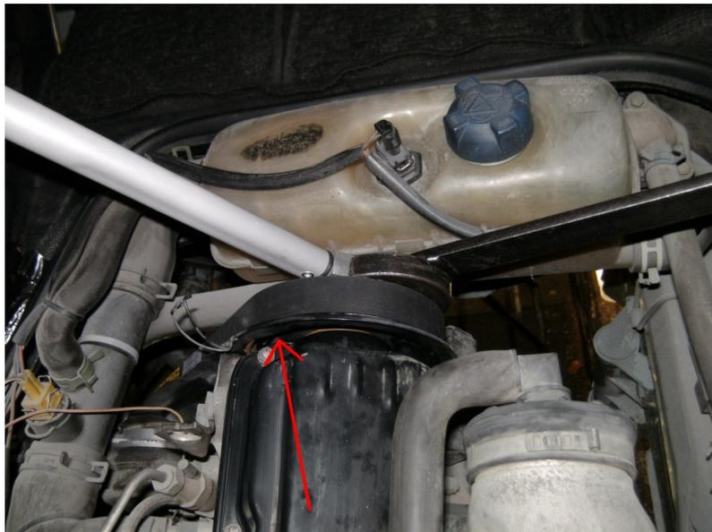
Oberes Nockenwellenrad mit VW 3036 Gegenhalter und 19-Nuß lockern. Das Einstelllineal soll dabei nicht als Gegenhalter dienen! Durch die kleine Öffnung (Pfeil) an der Zahnriemenschutzverkleidung mit einem Dorn einen kurzen Schlag auf das Zahnrad geben, damit es von der Achse geht (Konus). Dann weiter aufschrauben und Nockenwellenrad mit Zahnriemen abnehmen.
