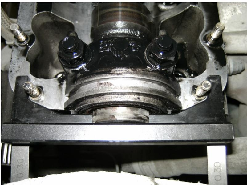
VW 2065A Einstelllineal eingesetzt. Manchmal muss man etwas mit einem Schraubendreher an den Zacken am Schwungrad drehen, bevor das Einstelllineal einzusetzen geht, falls die Nockenwelle noch nicht gerade ist.
