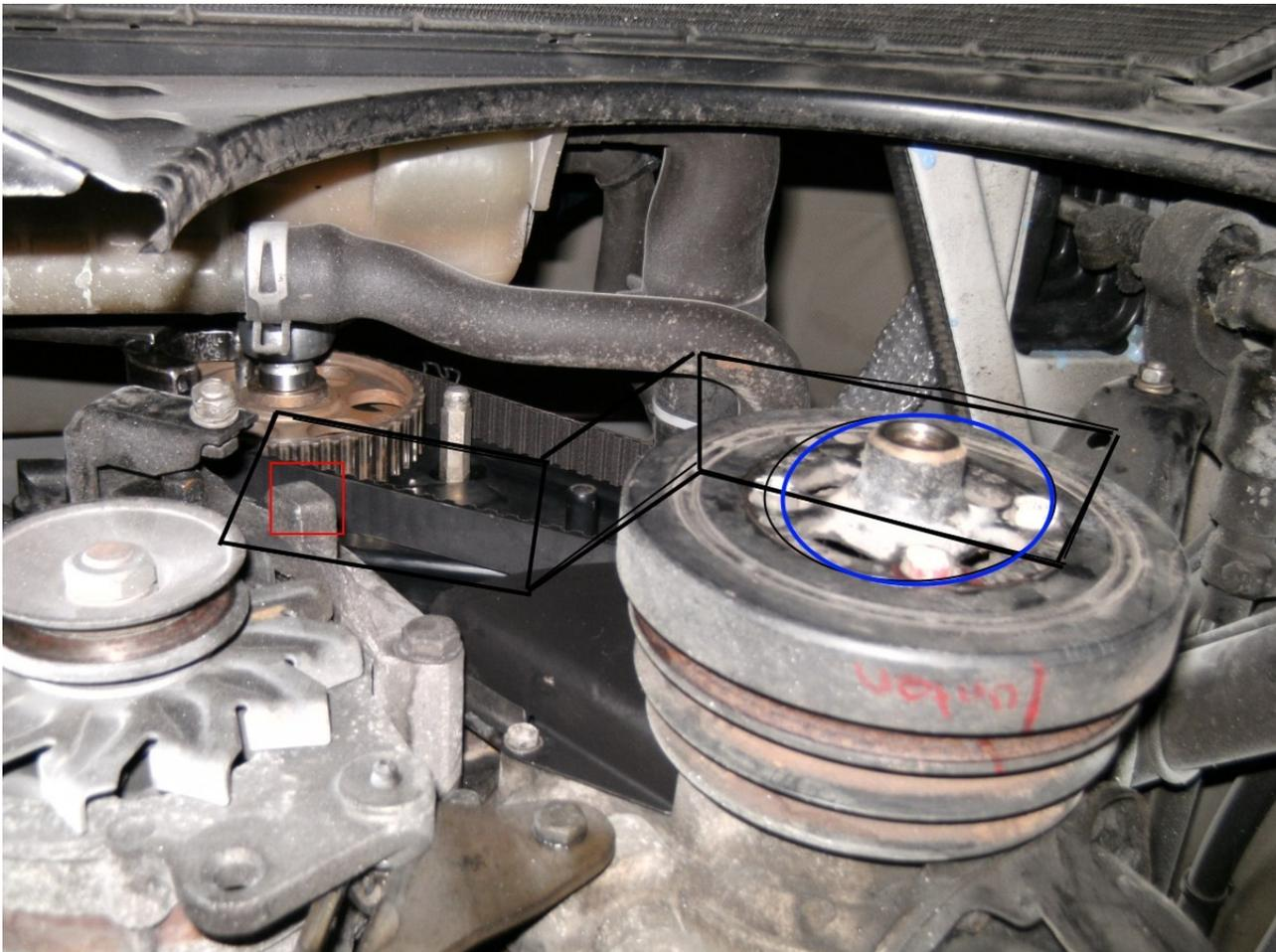
Nun wieder unters Auto. Mit der langen M8 Schraube können wir den mittigen Teil des Schwingungsdämpfers abziehen (mit blauer Ellipse eingekreist), vorher Schrauben lösen.
