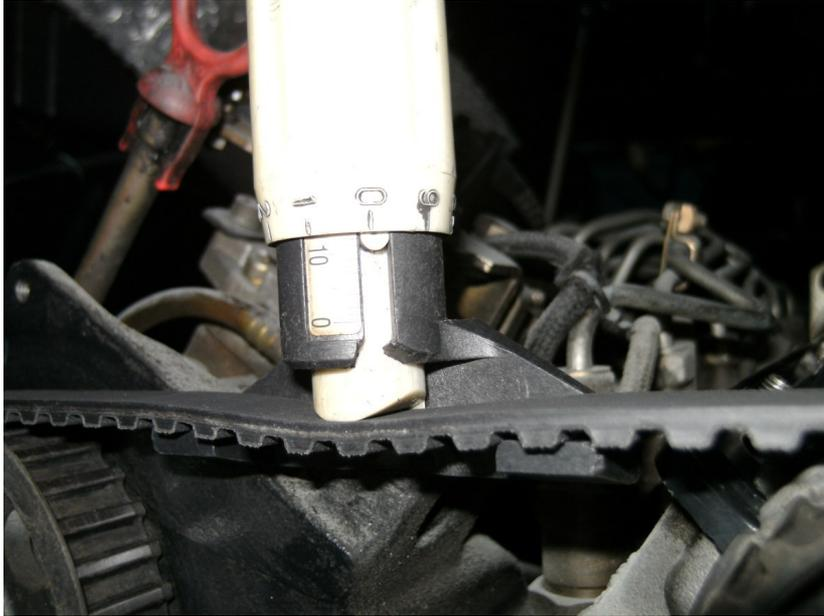
Hat man keinen Zahnriemenspannungsprüfer zur Hand, kann der Riemen zwischen Daumen und Zeigefinger geprüft werden. Er darf sich maximal 90 Grad drehen lassen.
