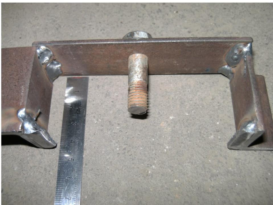
19 Nuß mit Vierkant in gekürzter Fassung selbst gebaut, da das Nockenwellenrad an der Front zu wenig Platz bietet für den Drehmomentschlüssel mit Knarre. Der Kühlmittelbehälter kann evt. gelöst werden, das habe ich nicht probiert.
