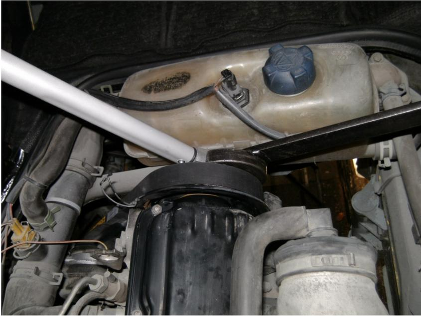
Einstelllineal entfernen. Die Dichtflächen am Nockenwellengehäuse beidseitig säubern und mit einer neuen Dichtung verschließen. Schrauben mit 10 Nm anziehen.
