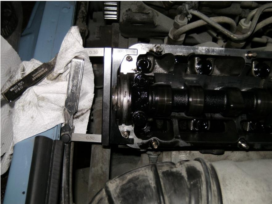
Der dritte Punkt ist an der Nockenwelle, das wird mit dem Einstellineal 2065A gemacht, dazu später mehr.
