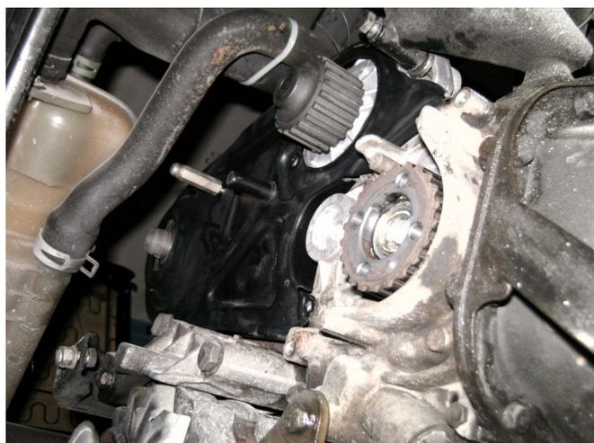
Die schwarze hintere Zahnriemenverkleidung anbringen, die Schrauben hierfür werden mit 10 Nm angezogen.
